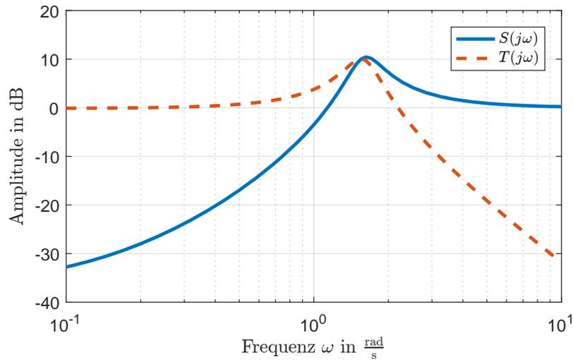
Abbildung 1: Amplituden von  $S(j\omega)$  und  $T(j\omega)$
